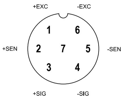
Para conexión 4 pines, puentear pines 1 con 2 y 5 con 6
